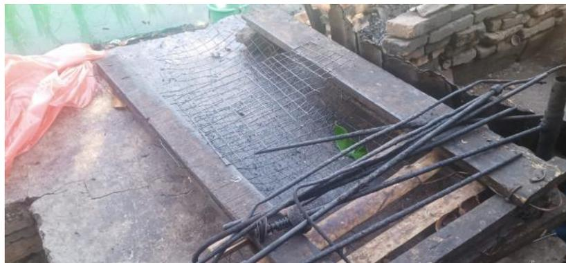
Gambar 2. Alat Untuk Pengasapan Ikan
