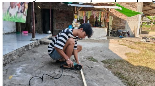
Memotong besi hollow galvanis menjadi 5 bagian dengan Panjang 1,5 meter
