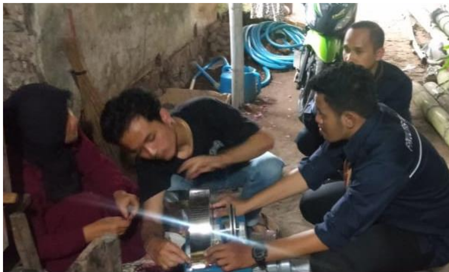
Gambar 6. Uji coba perawatan mesin yaitu pembersihan area pisau.
