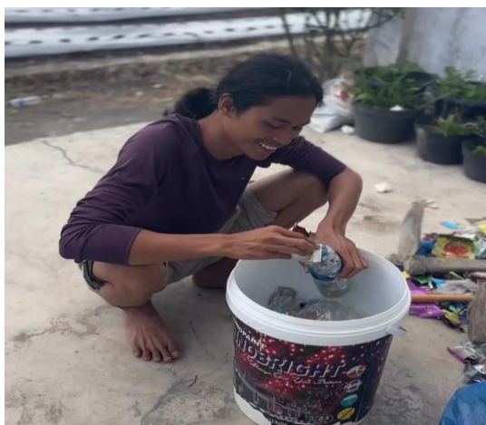
Gambar 8. Proses Memasukkan dan Memadatkan Sampah ke Dalam Botol.
