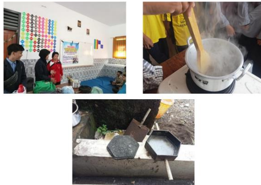
Gambar 3. Proses pelatihan pembuatan paving block berbahan plastik dengan metode manual.
