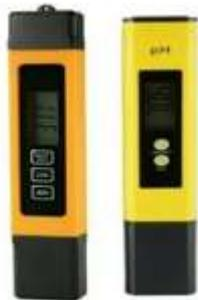
Gambar 1. Alat pengukur PH dan TDS air
